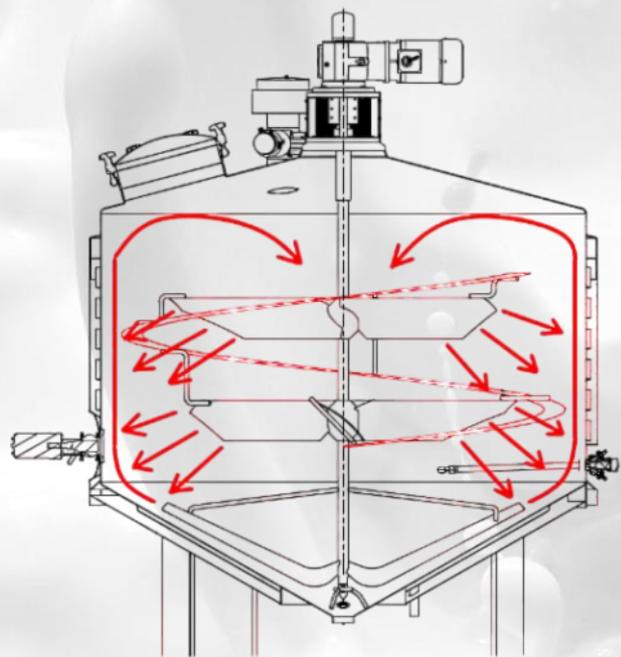
Геликоидная мешалка, позволяет при высоких угловых скоростях не развивать высокие линейные скорости лопастей, которые бережно перемещают продукт к стенкам емкости, а спиралевидные лопасти поднимают продукт вверх, образуя турбулентность.
